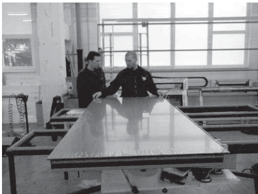
1. Zkušební uložení výplně do rámu křídla a kontrola vzájemného sesazení
