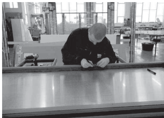
2. Rozměření a označení pozic otvorů (sloužících pro uchycení výplně) po obvodu rámu křídla dveří. Otvory je třeba umístit proti úchytným na bocích dveřní výplně.
