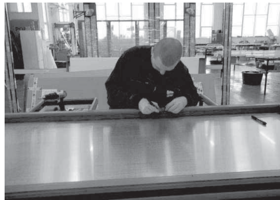
2. Rozměření a označení pozic otvorů (sloužících pro uchycení výplně) po obvodu rámu křídla dveří. Otvory je třeba umístit proti úchytkům na bocích dveřní výplně.
