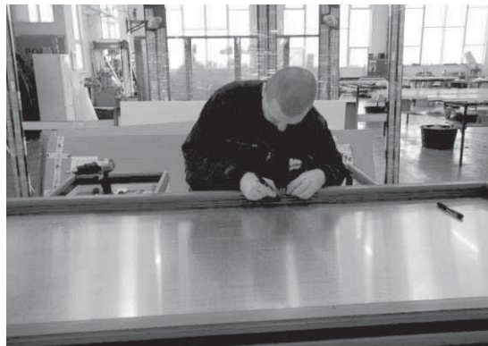
2. Rozměření a označení pozic otvorů (sloužících pro uchycení výplně) po obvodu rámu křídla dveří. Otvory je třeba umístit proti úchytům na bocích dvevní výplně.
