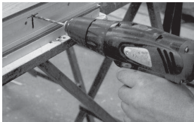
8. Vrtání otvorů pro šrouby do úchytů dveřní výplně.
